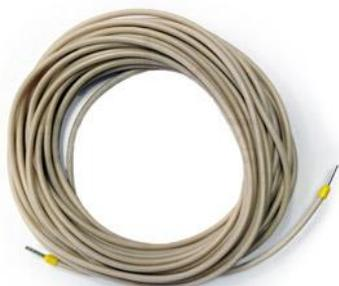
ПЭН устанавливается во внутренний контур уплотнителя дверного полотна в дверях камер шоковой заморозки. Мощность ПЭНа 20Вт/м.
