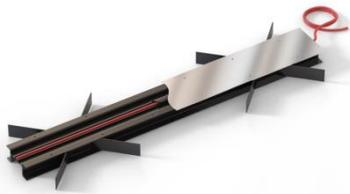
Усиленный обогреваемый дверной порог для безпороговых низкотемпературных дверей. Предотвращает примерзание нижней части уплотнителя к дверной раме. В порог устанавливается ПЭН мощностью 40Вт/м.
