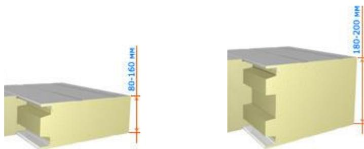
**Камера шоковой заморозки КМПФ-2,2-120.** Изготавливается из сэндвич-панелей с наполнителем их жесткого пенополиуретана европейского производства (плотность пены 42-45 кг/куб.м) толщиной 120 мм. Панели соединяются между методом тройного "шип-паза" уникальной конфигурации, которая обеспечивает: ликвидацию "мостиков холода"; жесткое соединение панелей; минимальный расход монтажной пены, герметиков при стыковке панелей. Объем камеры: 2,2 куб. м.
